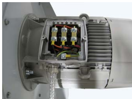
Рисунок 3.15 Подключение двигателя вентилятора
