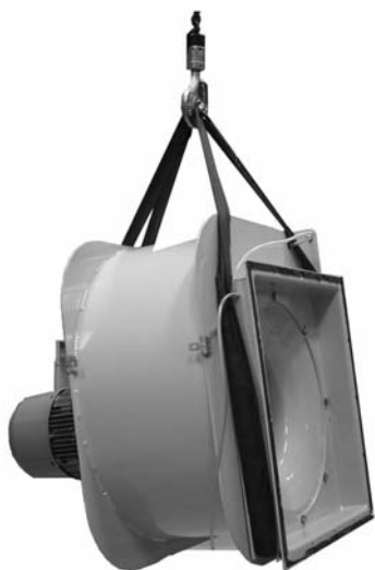
Рисунок 3.12 Подъем вентилятора воздуха реактивации
