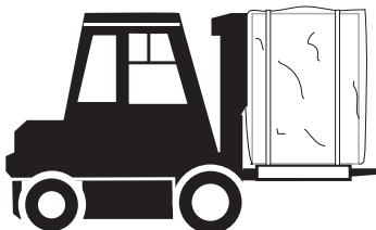
Figur 3.2 Rätt längd på gaffeltruckens armar
