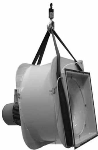
Abb 3.12 Anheben des Regenerationsventilators
