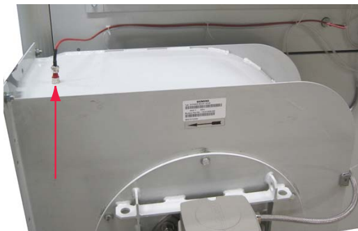
Abb 3.21 PT1000-Anschluss am Regenerationsventilator
