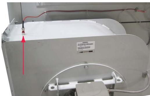
Figura 3.21 Conexión de PT1000 en el ventilador de reactivación
