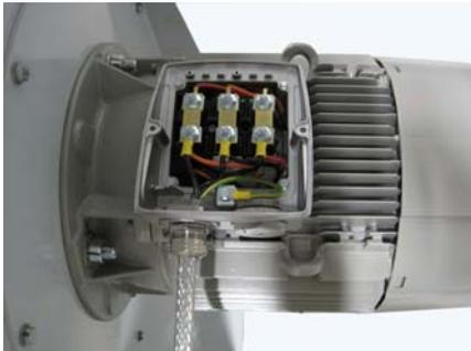
Figura 3.15 Cableado del motor del ventilador
