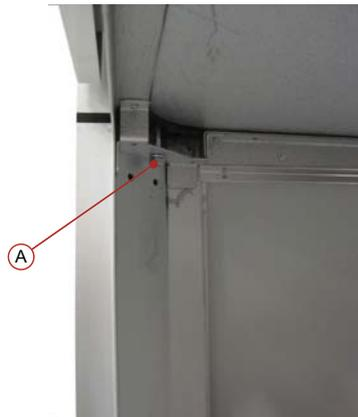
Figura 3.10 A: Tornillo M8 visto desde abajo.
