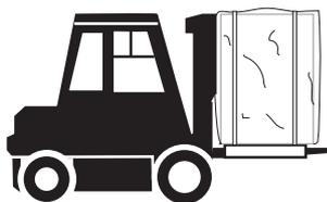
Figura 3.2 Longitud correcta de los brazos del elevador de horquillas
