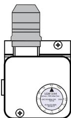
Figura 4.4 Interruptor de presión para corriente de aire de reactivación
