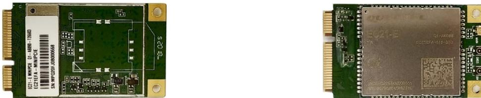
Figura 1: SIM 940-99-00049, vista trasera y delantera
