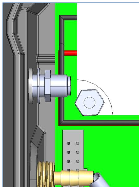
4. Rosqueie o cabo do modem no conector conforme ilustrado abaixo.
