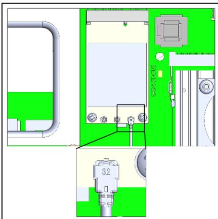
5. Rosqueie o cabo do modem no conector conforme ilustrado abaixo.
