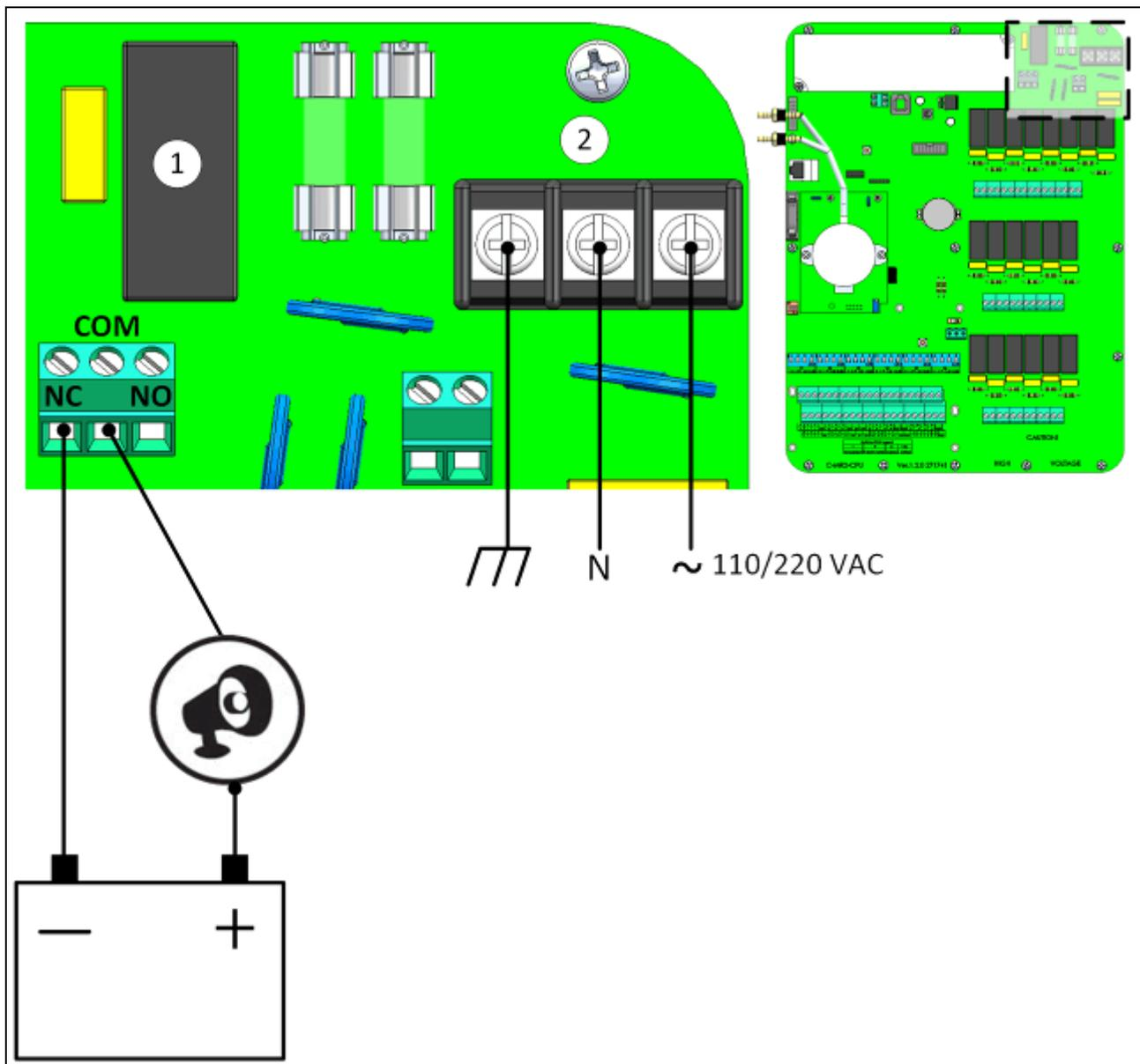
Figura 7: Portas de potência e relé de alarme
