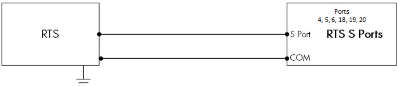
Figure 18: Diagrama esquemático da fiação do RTS Porta S
