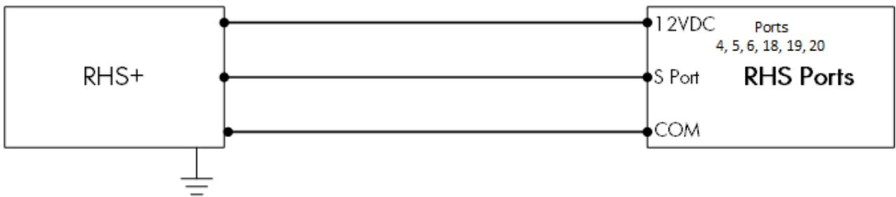
Figura 20: Diagrama esquemático da fiação sensor RHS+
