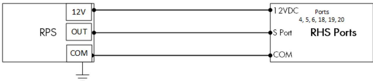
Figura 26: Diagrama esquemático da fiação do RPS
