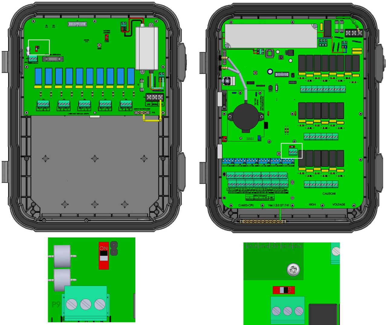
*NOTE* Quando o Trio não está conectado a um Trio Expansion, a posição da chave dip de terminação é irrelevante.
