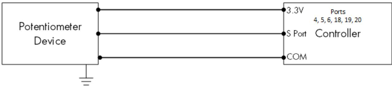
Figura 22: Diagrama esquemático da fiação do potenciômetro
