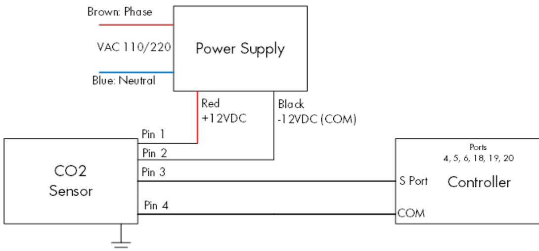
Figura 14: Diagrama esquemático da fiação do sensor de CO<sub>2</sub>
