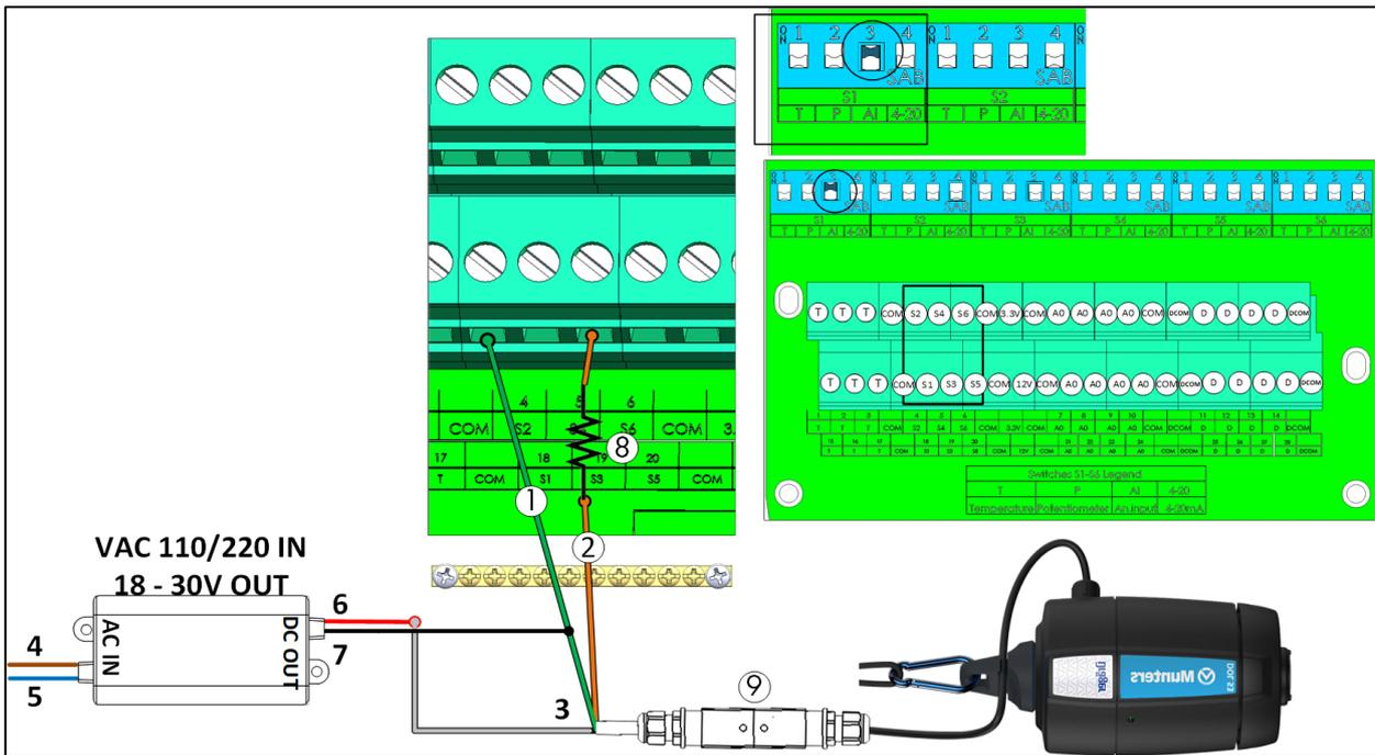
Figura 23: Fiação do Sensor de Amônia
