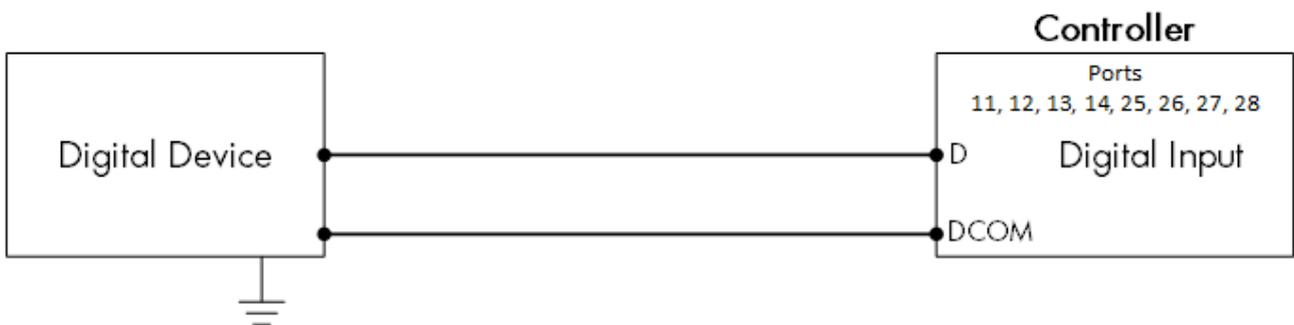
Figura 12: Diagrama esquemático da fiação de dispositivo digital
