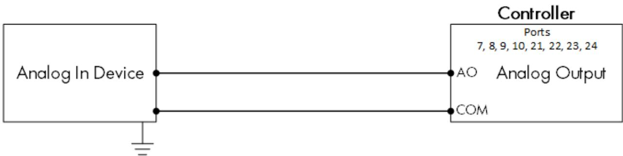
Figura 10: Diagrama esquemático da fiação de dispositivo analógico
